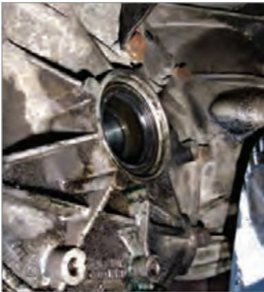
شکل ۲۸-۵- بررسی محل نصب پلوس
