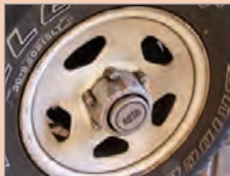
شکل ۵-۱- قفل روی چرخ (قفل پلوس) روی برخی خودروهای 4WD
