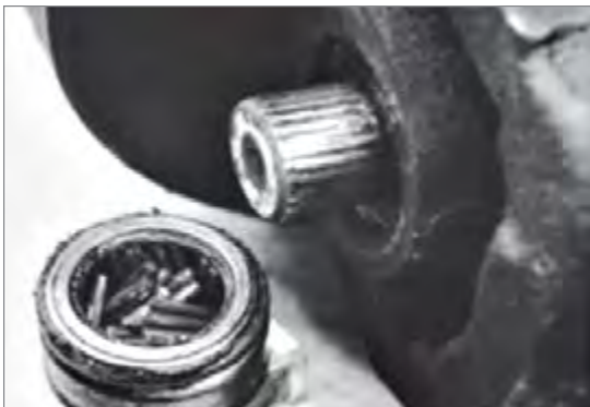
شکل ۲۳-۳- بررسی ساچمه سوزنی
