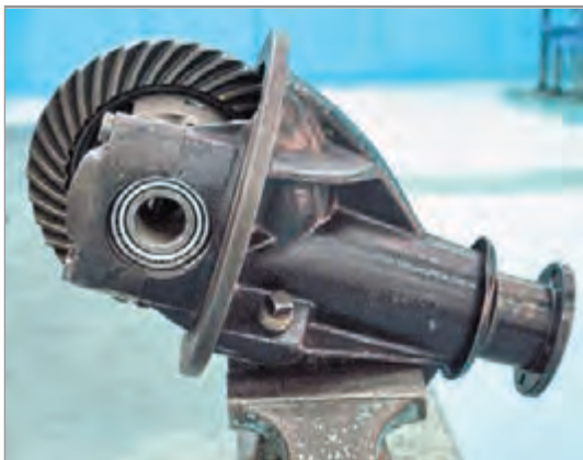
شکل ۲۷-۴- بستن مجموعه دیفرانسیل روی گیره
