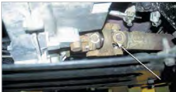
شکل ۶-۳- گاردان با چهارشاخه دویل
