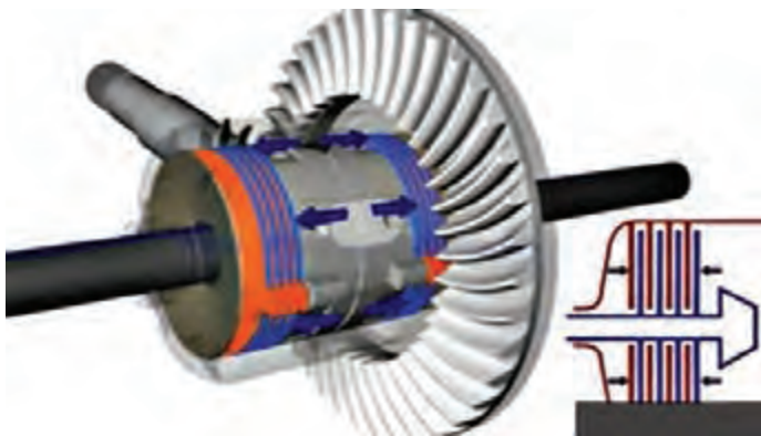
شکل ۴-۵ عملکرد دیفرانسیل ضد لغزش
