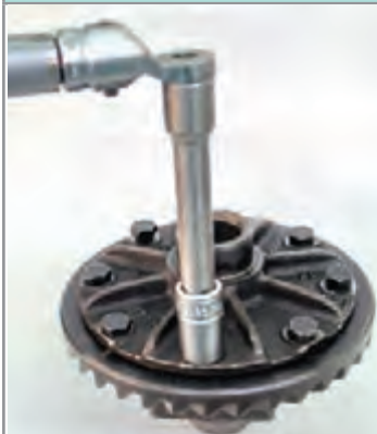
شکل ۵۰-۴- بستن پیچ‌های کرانویل
