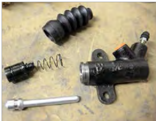
شکل ۱-۲۴- اجزای سیلندر اصلی کلاچ
