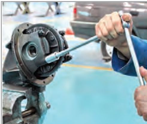
شکل ۵۳-۴- بستن کپه یاتاقان‌ها
