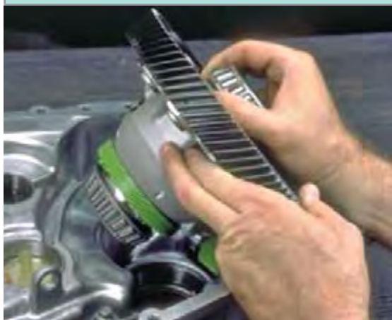
جدا کردن اجزای مجموعه جعبه دنده از روی محورها با کمک پرس و ابزار مخصوص
