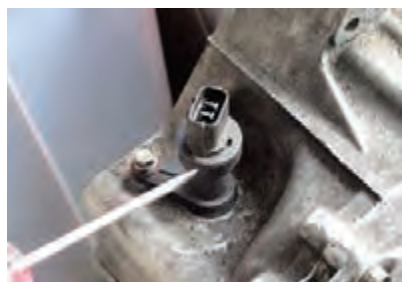
شکل ۲۶-۲ روش تعویض میکروسویچ دنده عقب و حسگر سرعت
