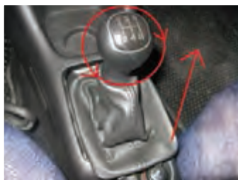
شکل ۲-۲۵- بیرون آوردن سری و گردگیر دسته دنده
