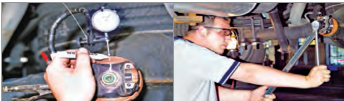
شکل ۲۵-۳- بررسی لنگی فلانچ و گشتاور سنجی مهره مرکزی دیفرانسیل
