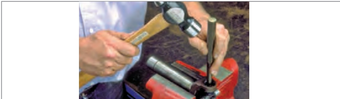
شکل ۲۱-۳- مراحل باز کردن اجزای گاردان
