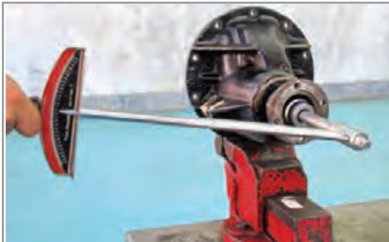
شکل ۴۸-۴- (ب) تعیین گشتاور پیش بار با گشتاورسنج
