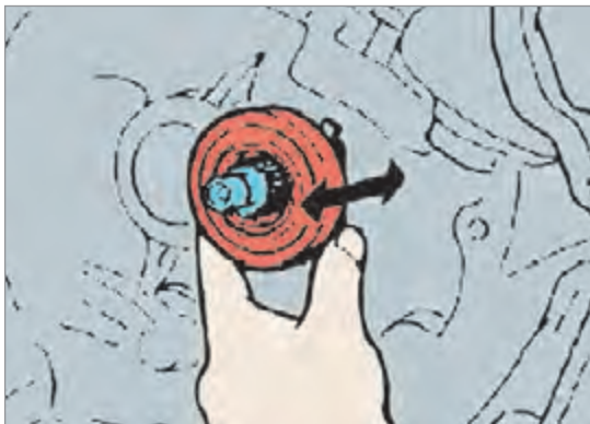
شکل ۱-۴۰- روش بررسی حرکت بلبرینگ کلاچ روی شفت کلاچ
