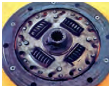
شکل ۱-۲۷- نمونه صفحه کلاچ معیوب (سوختگی و سایش بیش از حد)
