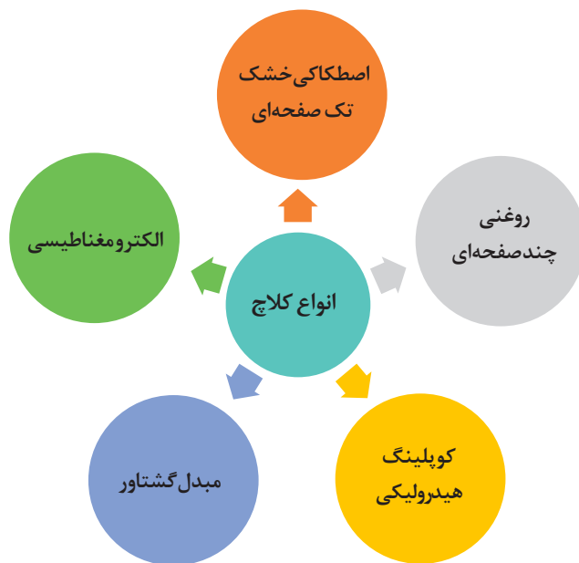
شکل ۷-۱- نمودار انواع کلاچ‌ها
