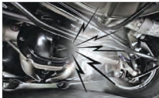
شکل ۸-۴- علل صدای غیر عادی دیفرانسیل
