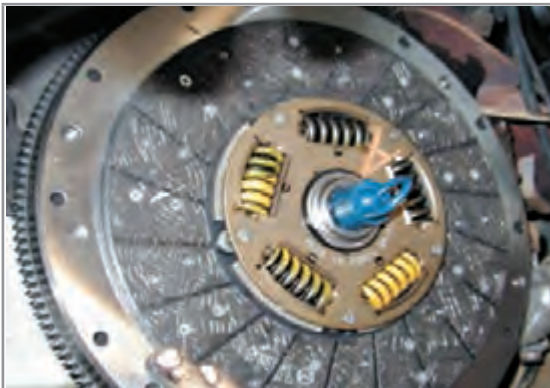
شکل ۱-۳۷- روش قرارگیری شفت هم‌محورکننده صفحه کلاچ
