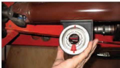
شکل ۱۳-۳- روش استفاده از زاویه سنج میل گاردان
