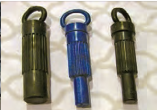
شکل ۱-۳۶- نمونه‌هایی از ابزار هم‌محورکننده صفحه کلاچ
