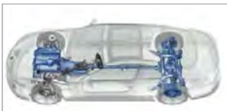
شکل ۳-۲- انتقال توان به مجموعه «گرداننده نهایی» با میل گاردان
