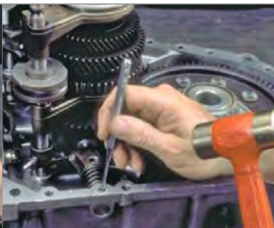
بیرون آوردن پین نگهدارنده اهرم تعویض دنده
