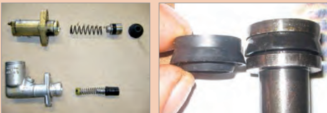
شکل ۲۱-۱- الف - نشتی داخلی در مدار هیدرولیکی
