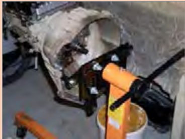
شکل ۲-۳۰- انواع پایه تعمیراتی جعبه‌دنده و روش بستن آن
