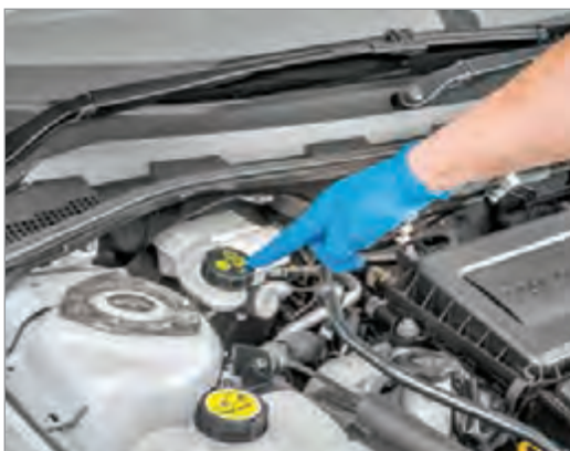
شکل ۱۶-۱- مخزن مایع مشترک در یک خودرو
