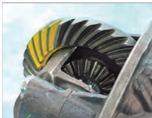
شکل ۴-۲۸- استفاده از رنگ برای آزمایش
