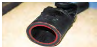
شکل ۱۱-۳- مقطع گاردان دولایه با لایه لاستیک میانی
