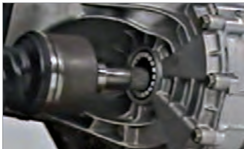
شکل ۲۱-۵- بیرون آوردن پلوس با ابزار مخصوص
