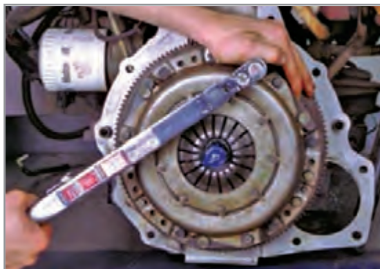
شکل ۱-۳۹- روش به گشتاور رساندن پیچ‌های دیسک کلاچ
