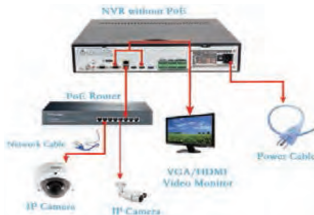
شکل ۱۷- اتصال دوربین به NVR
