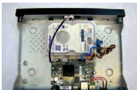
شکل ۳۵- محکم کردن دیسک سخت در محل نصب
