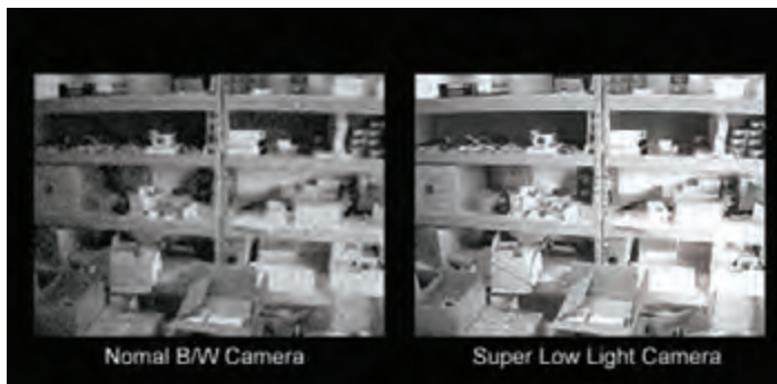
شکل ۱۸- تأثیر مشخصه Minimum Illumination در تصویر
