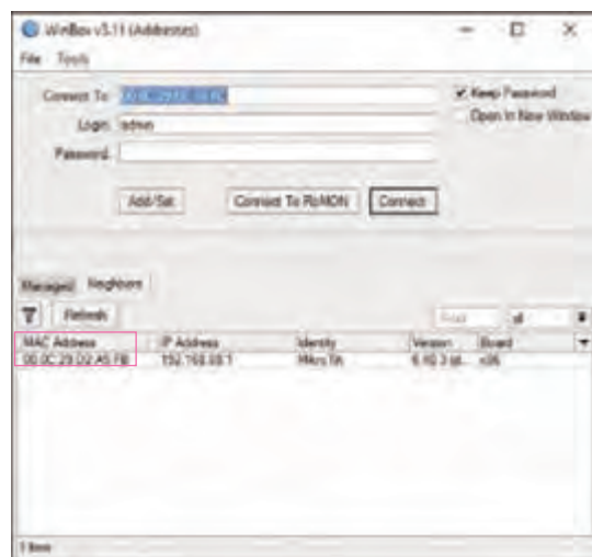
شکل ۶- اتصال به مسیریاب از طریق MAC Address
