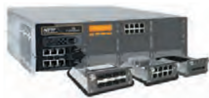
شکل ۱۱- یک نمونه فایروال سخت افزاری
