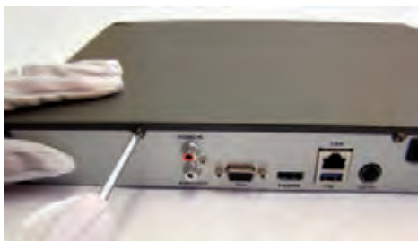
شکل ۳۲- بازکردن درپوش NVR
