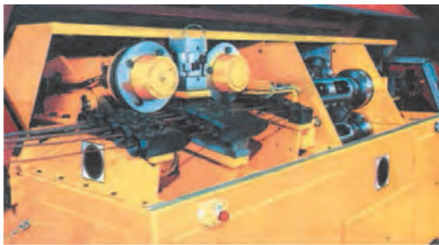
شکل ۲۹ - دستگاه کشش برقی برای صاف کردن میلگرد ▲
