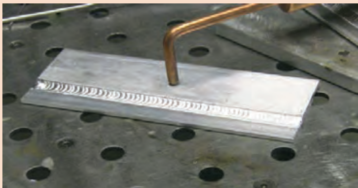
شکل ۱۷- اتصال لب روی هم نهایی
