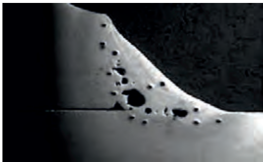
شکل ۳۱- مک و تخلخل در جوشکاری قطعات پلاستیکی
