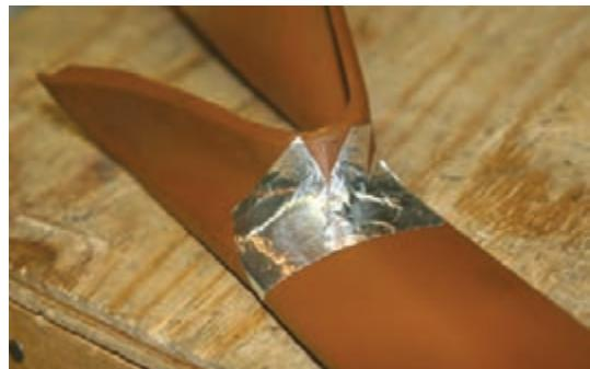
شکل ۲۸ - هم‌تراز کردن قطعه به کمک فویل آلومینیومی
