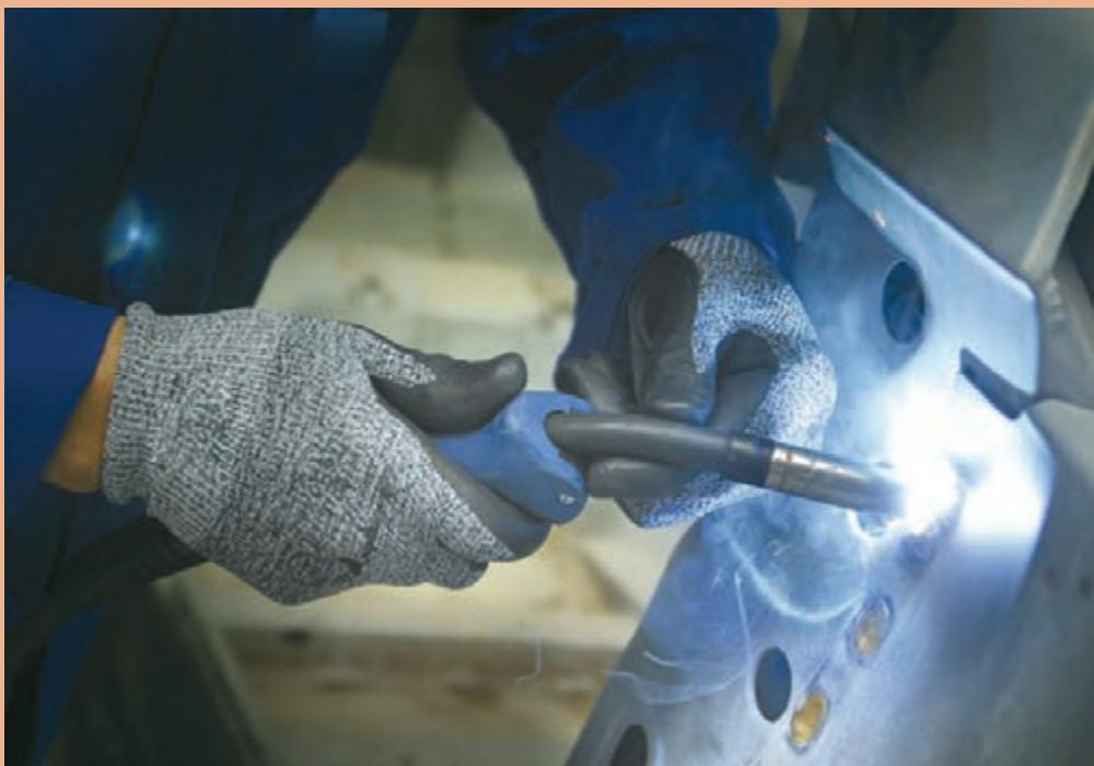
فلزات غیرآهنی در تولید صنعتی دنیا کاربردهای بسیاری دارند و اتصال آنها به صورت هم جنس یا غیر هم جنس بسیار معمول است. لحیم کاری سخت نسبت به جوشکاری نیاز به دمای کمتری دارد. در صنایع نیروگاهی، صنایع هوا - فضا، سیستم‌های برودتی، دستگاه‌های الکترونیک، پتروشیمی، خودروسازی و لوازم خانگی از این روش استفاده می‌شود.
