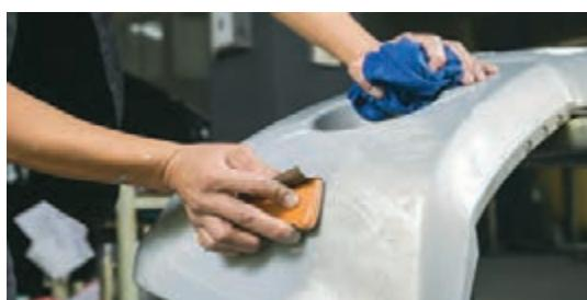
شکل ۳۰ - پولیش قطعه کار پس از تعمیر
