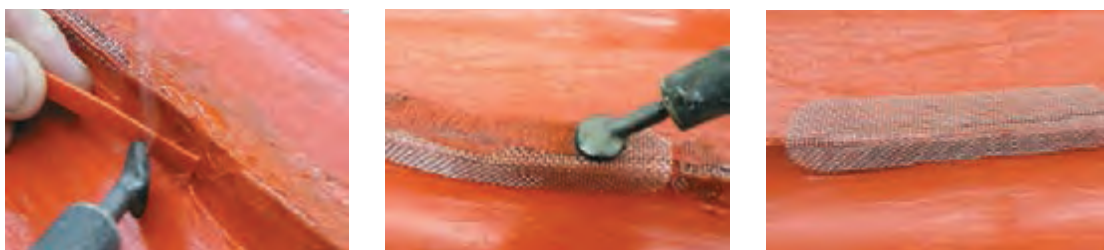
شکل ۲۹- استفاده از توری فلزی در تعمیر قطعات پلاستیکی
