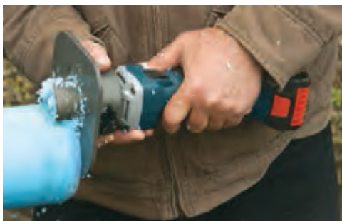
شکل ۲۴- پخ زدن قطعات پلاستیکی برای جوشکاری
