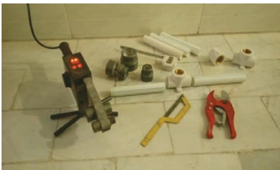
شکل ۱۹- تجهیزات جوشکاری لوله‌های پلاستیکی
