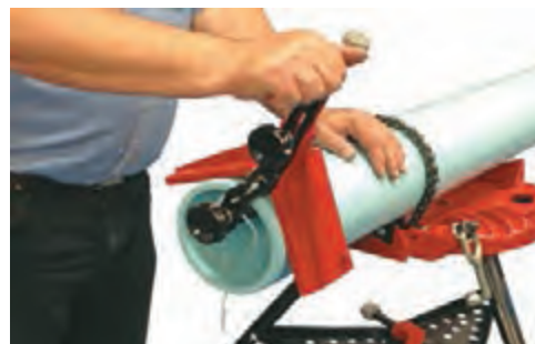
شکل ۲۴- پخ زدن قطعات پلاستیکی برای جوشکاری
