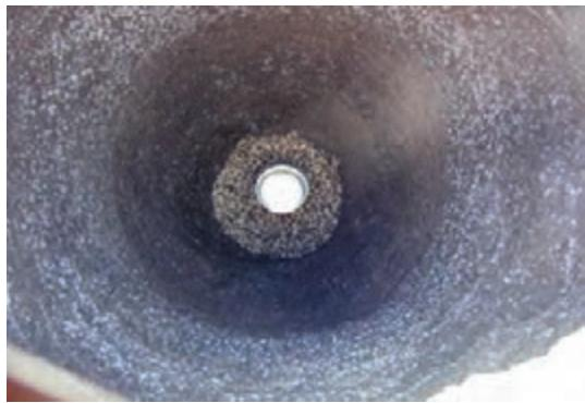
شکل ۲۰- استقرار دیسک ذوب شونده در انتهای بوته
