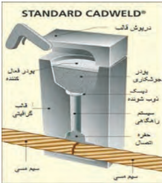
شکل ۲۷- تجهیزات جوشکاری احتراقی
