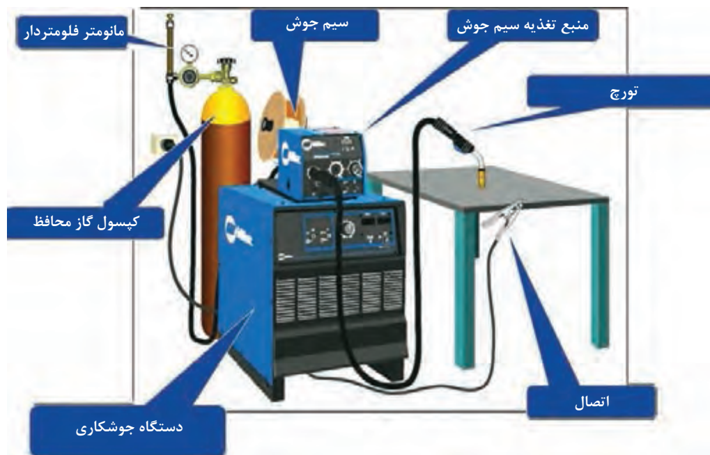
شکل ۶- قسمت های مختلف دستگاه جوشکاری FCAW
