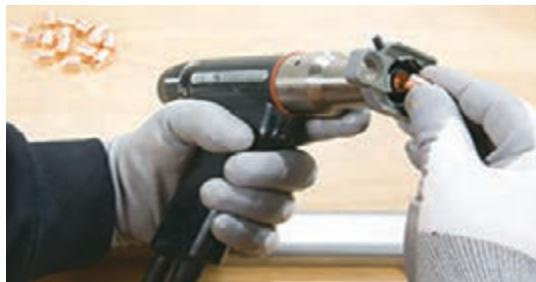
شکل ۱۹— قرار دادن گل میخ در داخل نگهدارنده
