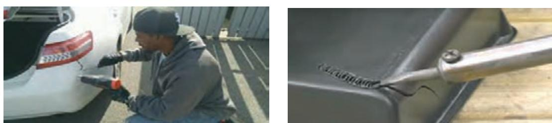
شکل ۲۲- جوشکاری تعمیری قطعات پلاستیکی
