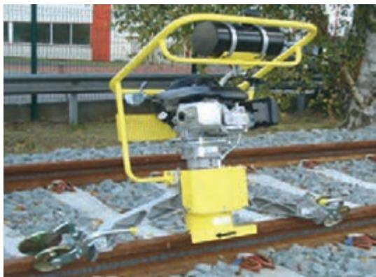
شکل ۱۳- ماشین اتوماتیک سنگزنی گرده اضافی جوش
