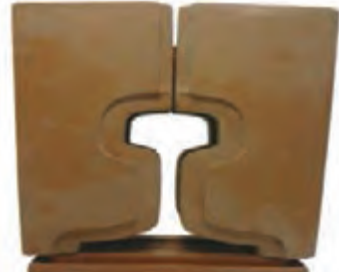
شکل ۷- قالب جوشکاری ترمیت و قرارگیری آن در اطراف ناحیه اتصال
