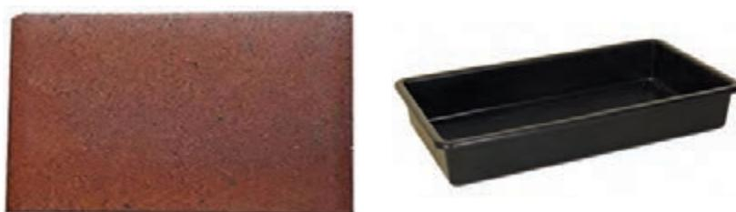
شکل ۸- سینی و آجر نسوز قالب جوشکاری
