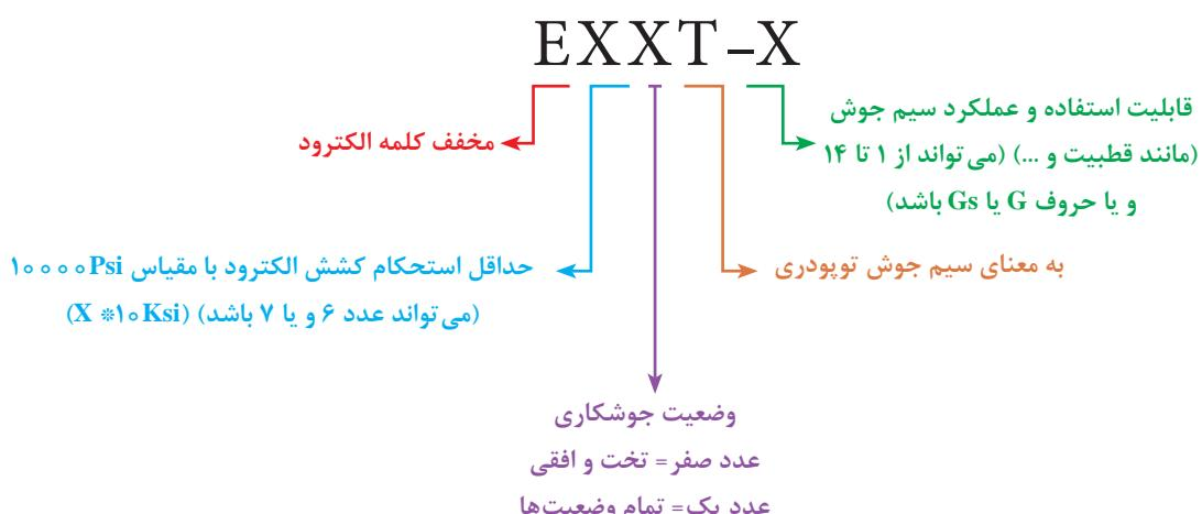
فولادهای ساده کربنی پر کاربردترین نوع فلزات هستند. در طبقه‌بندی سیم جوش‌های توپوپدری در فولادهای ساده کربنی، خط تیره و رقم به کار می‌رود. این خط تیره و ارقام برای نشان دادن قطبیت و نوع گاز محافظه مورد استفاده قرار می‌گیرد.
