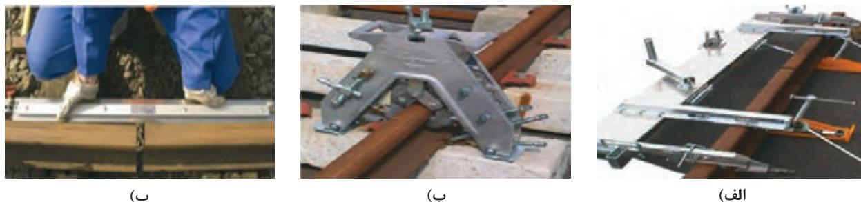
شکل ۱۰- ابزار تراز ریل (الف) صفحه تراز، (ب) تراز A شکل و (پ) تراز
