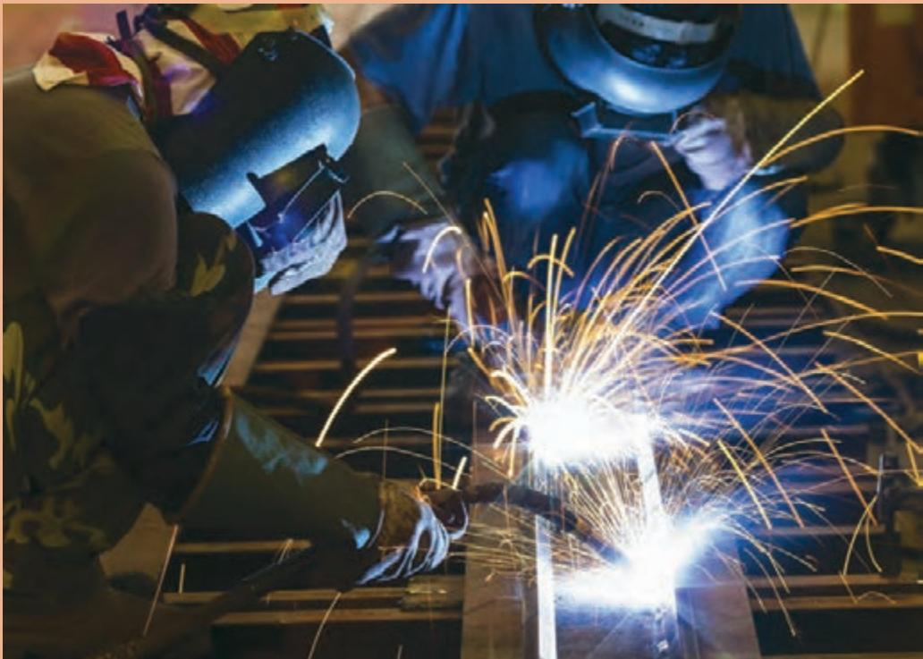
فرایند FCAW ترکیبی از فرایندهای GMAW و SMAW می‌باشد که محدودیت‌های این دو روش را برطرف نموده است. یکی از محدودیت‌های SMAW عدم به کارگیری آن به صورت اتومات می‌باشد. فرایند GMAW نیز فرایندی است که با استفاده از سیم جوش‌های توپر (Solid) و گاز محافظت کاربردش در هوای آزاد به دلیل وزش باد با مشکلاتی همراه است علاوه بر این مزیت سیم جوش‌های توپو دری نسبت به سیم جوش‌های توپر، به کارگیری عناصر دلخواه در پودر این نوع سیم جوش‌ها می‌باشد.
