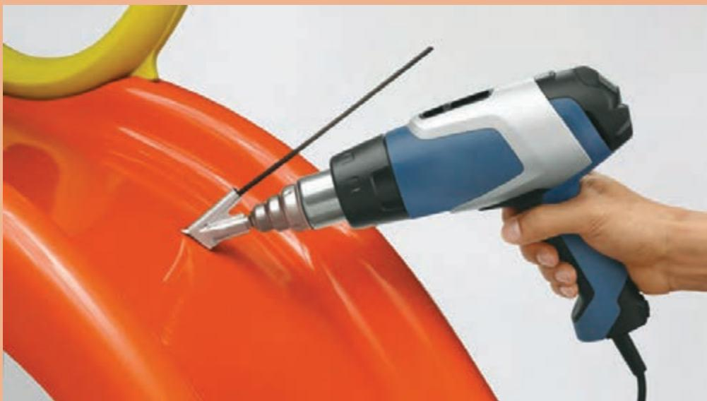
امروزه پلاستیک‌ها (پلیمرها) به دلیل خواصی مانند نسبت استحکام به وزن بالا، مقاومت در برابر خوردگی، شکل‌پذیری مناسب و هزینهٔ پایین کاربردهای فراوانی یافته‌اند. نظر به اینکه از فرایندهای جوشکاری برای اتصال و تعمیر قطعات پلاستیکی استفاده می‌شود، بنابراین مطالعه و بررسی نحوه جوشکاری پلاستیک‌ها حائز اهمیت می‌باشد.
