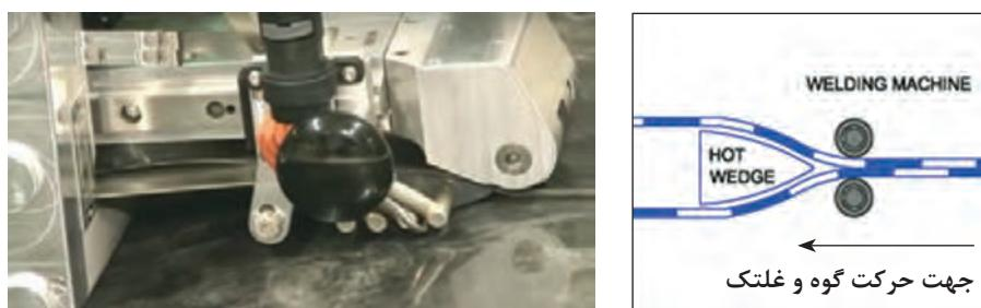
شکل ۶- جوشکاری با گوه داغ (Hot Wedge) و دستگاه جوش آن
