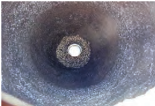
شکل ۲۰- استقرار دیسک ذوب شونده در انتهای بوته
