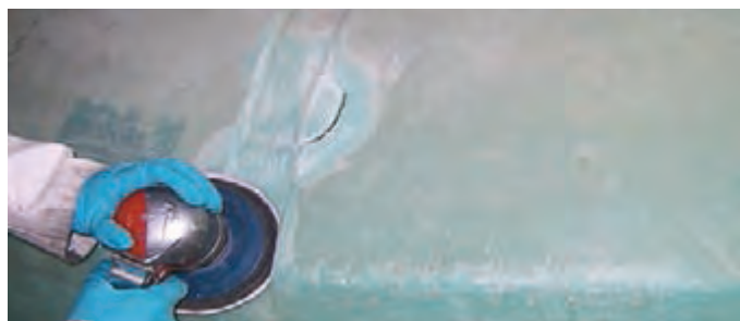
شکل ۲۶- آماده‌سازی سطوح پلاستیکی قبل از جوشکاری
