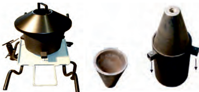
شکل ۶- بوته نگهدارنده مذاب
