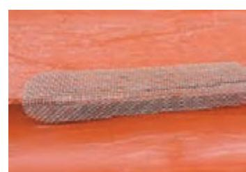
شکل ۲۹ - استفاده از توری فلزی در تعمیر قطعات پلاستیکی
