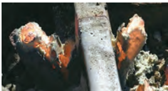
شکل ۲۴- برش گرده اضافی جوش
