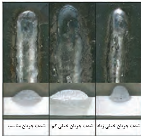
شکل ۱۷- تأثیر سرعت حرکت دست، شدت جریان و ولتاژ بر ظاهر جوش
