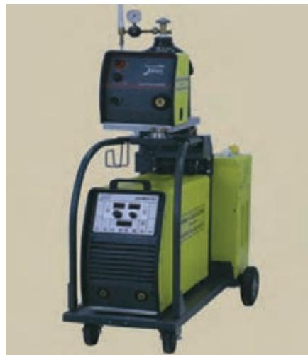
شكل ۲۲- نمایی از دستگاه میگ بریزینگ
