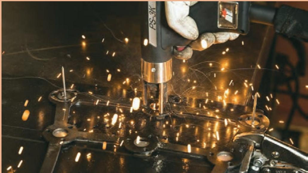
گل میخ یک فرایند قوسی است که در اثر گرمای ایجاد شده قوس الکتریکی، یک زائد (گل میخ) را به فلز پایه متصل می‌کند. این فرایند کاربرد بسیاری در صنعت دارد.
