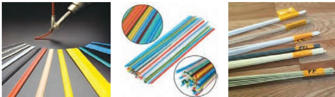
شکل ۱۳- انواع مفتوحهای پلاستیکی جوشکاری
