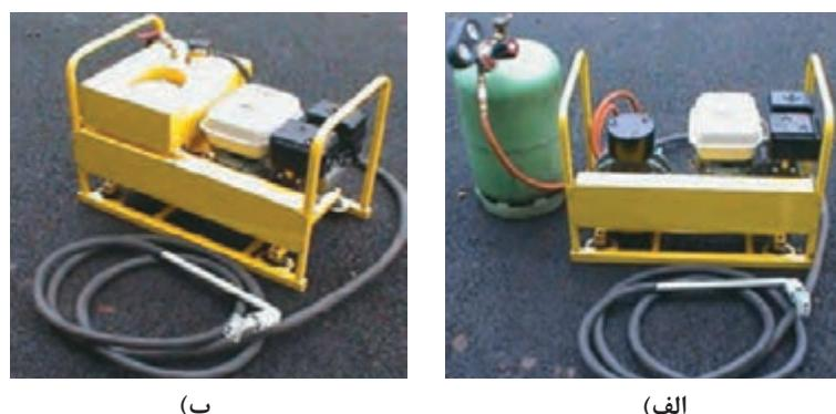
شکل ۱۱- تجهیزات پیش گرمایی در جوشکاری ریل راه آهن، (الف) باساخت پروپان (ب) با گازوئیل
