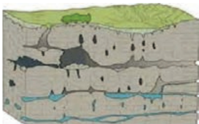
ریزش سقف غارها و تشکیل کارست
