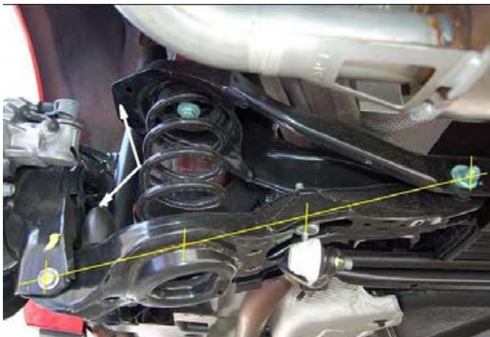
شکل ۵۰ - محل اتصالات قابل تنظیم جهت تنظیم زوایای کمبر و سر جمعی
