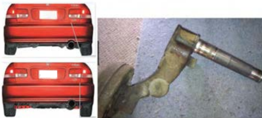
شکل ۴۶- خرابی بوش‌ها و تأثیر آن روی چرخ
