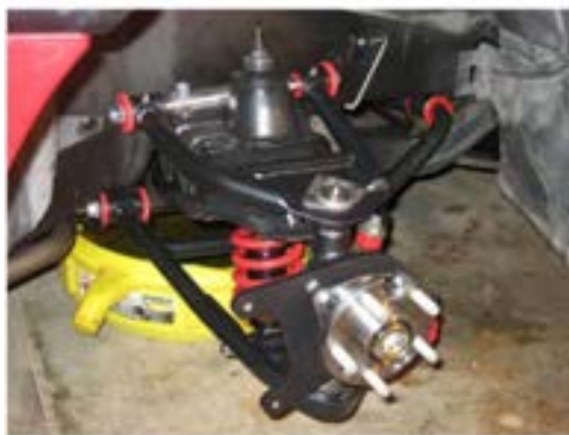
شکل ۴۰- مجموعه تعلیق طبق دار دوبل و روش تنظیم زوایا
