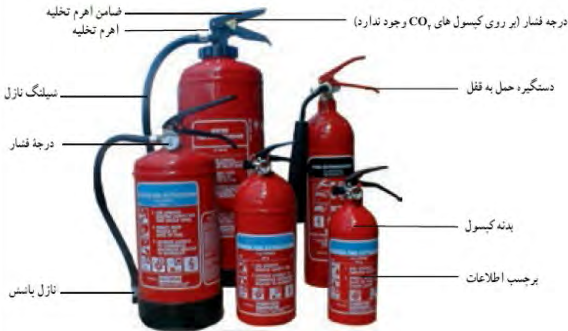
اجزای کپسول های اطفای حریق
