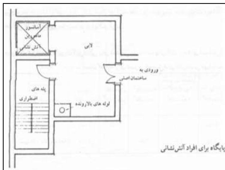
از این لابی‌ها افراد آتش‌نشانی باید به لوله آب آتش‌نشانی<sup>۱</sup> دسترسی داشته باشند. اینها لوله‌هایی هستند که به طور عمودی در ساختمان کار گذاشته شده‌اند و مجهز به پمپ‌های تقویت‌کننده در پایین بوده و در هر طبقه دارای خروجی می‌باشند. لوله‌های خشک خالی از آب
