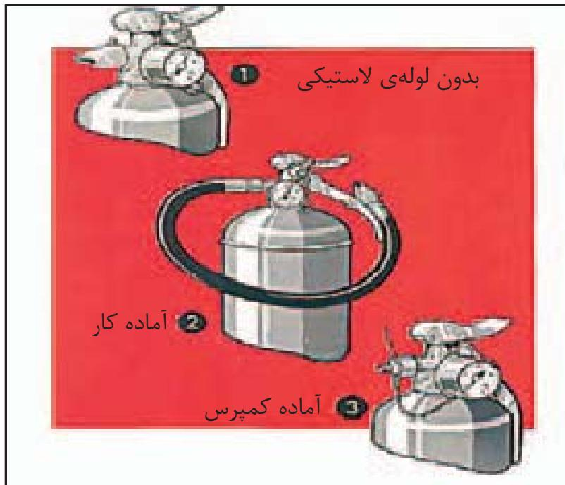
۵. برای پُر کردن هوا، معمولاً هوا را با عبور از فیلترهای رطوبت گیر، خشک و به داخل بدن کمپرس می‌کنند؛ زیرا در غیر این صورت رطوبت هوا جذب پودر شده و پودر کلوخه می‌شود.
