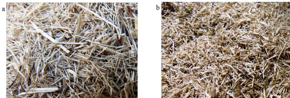
Fig. 1. (a) Nascent bagasse (b) Bagasse fiber.
