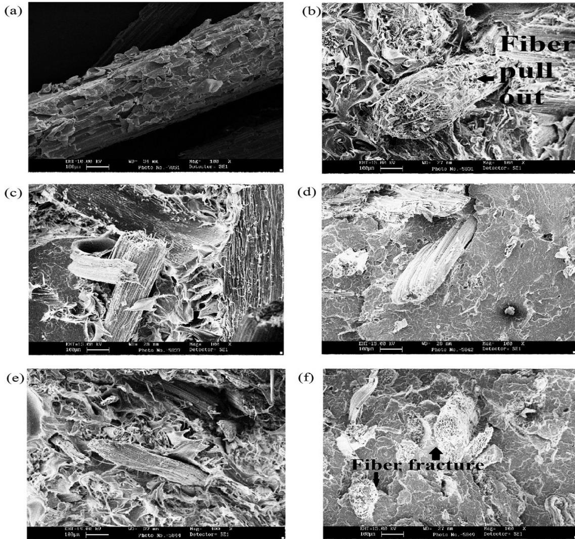
Fig. 3. SEM images of (a) Bagasse fiber (b) BFPP (c) RC1 (d) RC2 (e) RC3 (f) RC4.
