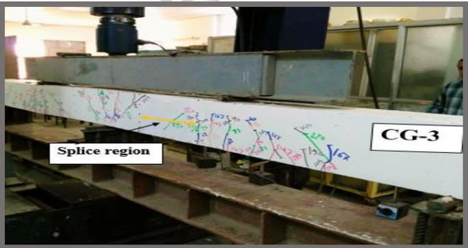
(d) Girder CG-3(direct shear failure)
