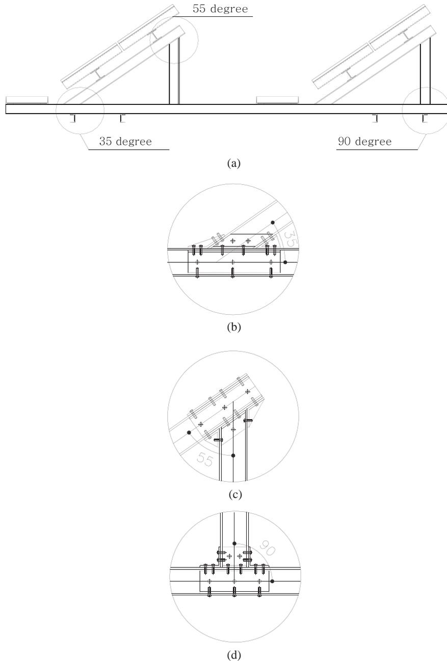
Fig. 4. Details of connection part. (a) Connection, (b) 35°, (c) 55° and (d) 90°.
