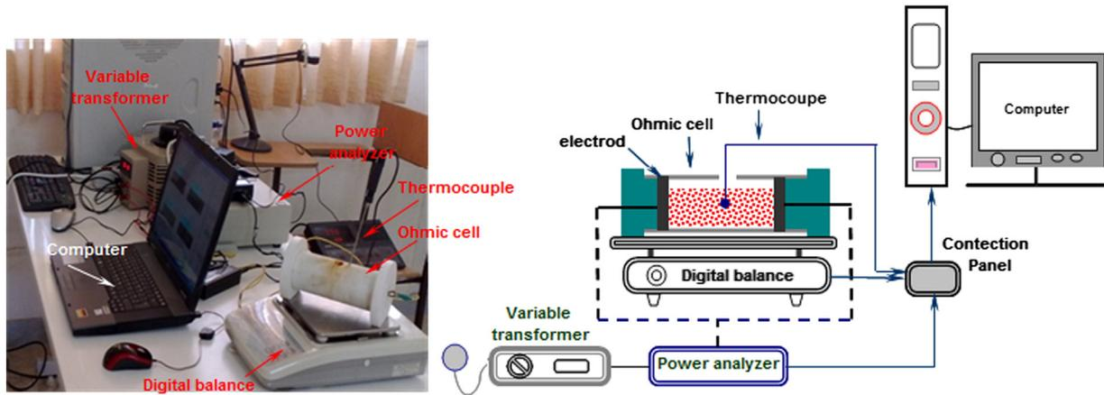
Fig. 1. Experimental apparatus.
