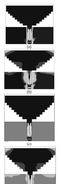
(d) Fig. 11. Current Distribution with U-shaped slot (a) CPW 5.5GHz (b) CPW 8.0GHz (c) MS 5.5GHz (d) MS 8.0GHz
