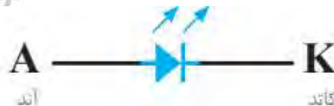
شکل ۲۷- نماد LED در نقشه های الکتریکی و الکترونیکی
