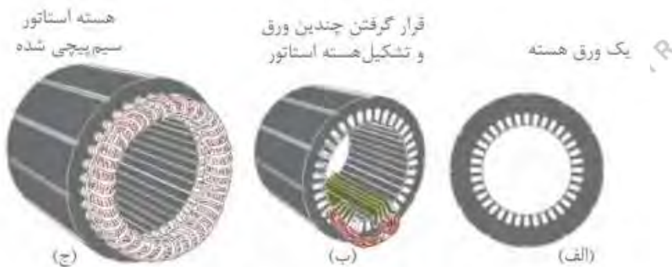
شکل ۵- اجزای استاتور موتورهای آسنکرون
