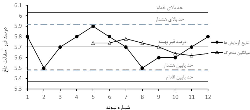
شکل ۲۰-۳- نمودار کنترلی درصد قیر آسفالت داغ
