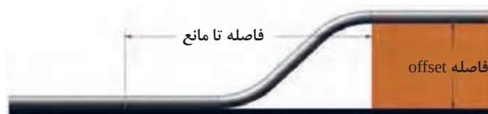
شکل ۳۵- هم‌راستا کردن امتداد لوله
