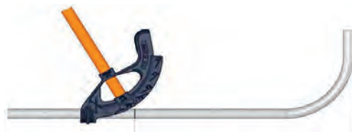
شکل ۲۷- اجرای خم دوم
