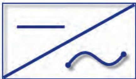
شکل ۴- تبدیل ولتاژ مستقیم به متناوب
