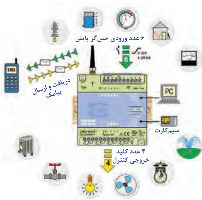
شکل ۱۷- کاربردهای متنوع سامانه کنترل پیامکی
