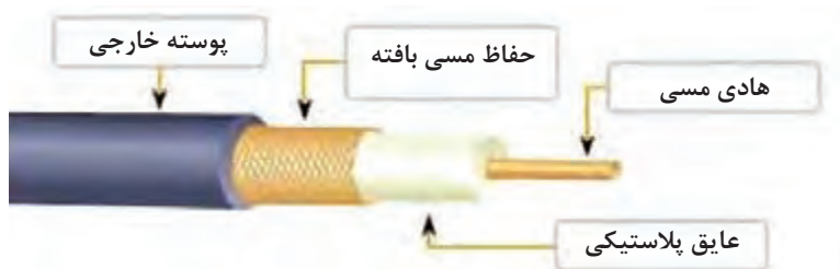
شکل ۳- اجزای کابل کواکسیال
