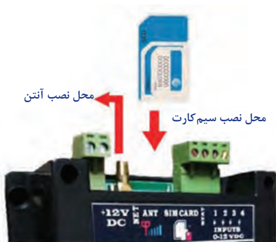
شکل ۱۹- محل نصب آنتن و سیم کارت
