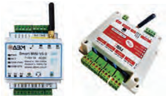
۱۶- سامانه کنترل از راه دور با پیامک
