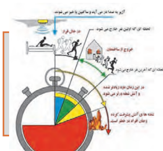
شکل ۳۰- مدیریت زمان هنگام اعلام حریق
