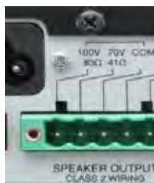
شکل ۲۳- الف - اتصال ولتاژ بالا
