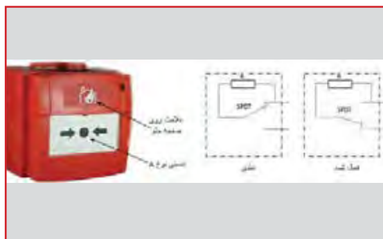
شکل ۷ - شستی اعلام حریق و نحوه فعال‌سازی آن
