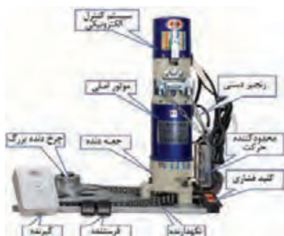
شکل ۷- اتصالات موتور الکتریکی در کرکره‌ای
