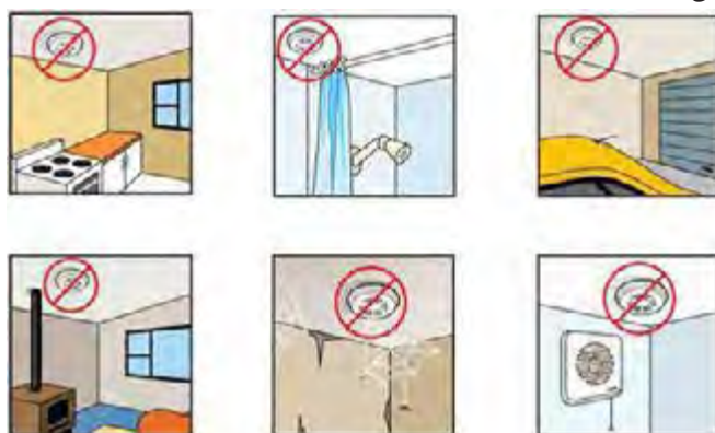
شکل ۶۷- محل‌های نامناسب نصب دتکتور
