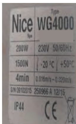
شکل ۲۴- مشخصات فنی بازو (در بازویی)
