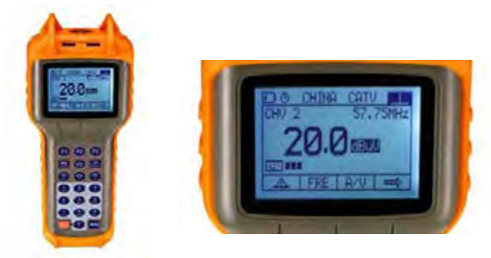
شکل ۲۴- اندازه‌گیری سیگنال خروجی آنتن توسط سیگنال سنج
