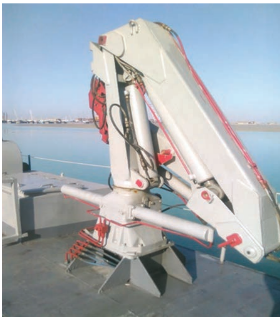
شکل ۲۲- جک هیدرولیکی بر عرشه یک شناور
