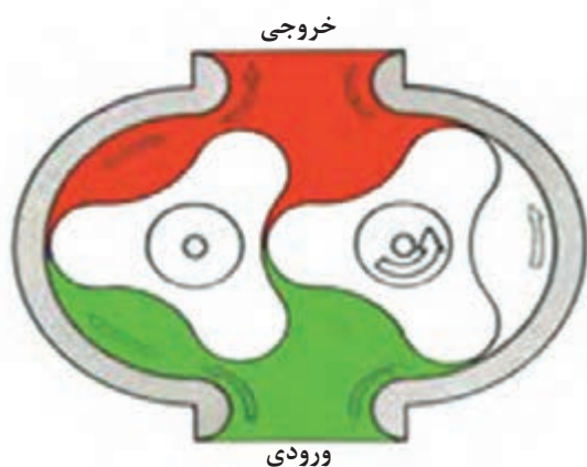
شکل ۸- ساختمان و نمای داخلی پمپ گوشواره‌ای
