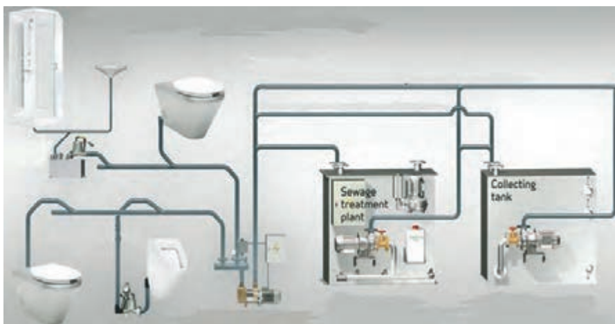
شکل ۱۴- نمودار سامانه دفع فاضلاب یک کشتی
