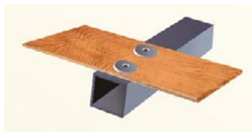
شکل ۳-۲۴ اتصال قطعات غیر فلزی
