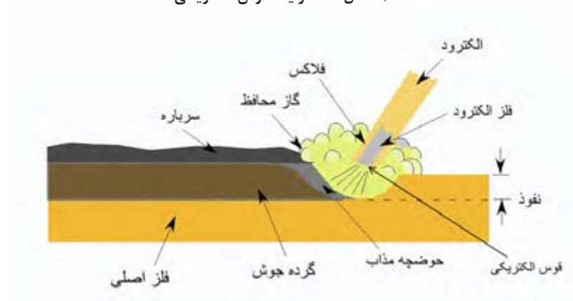
ب) شکل ۴-۳ فرایند قوس الکتریکی را نشان می دهد.
