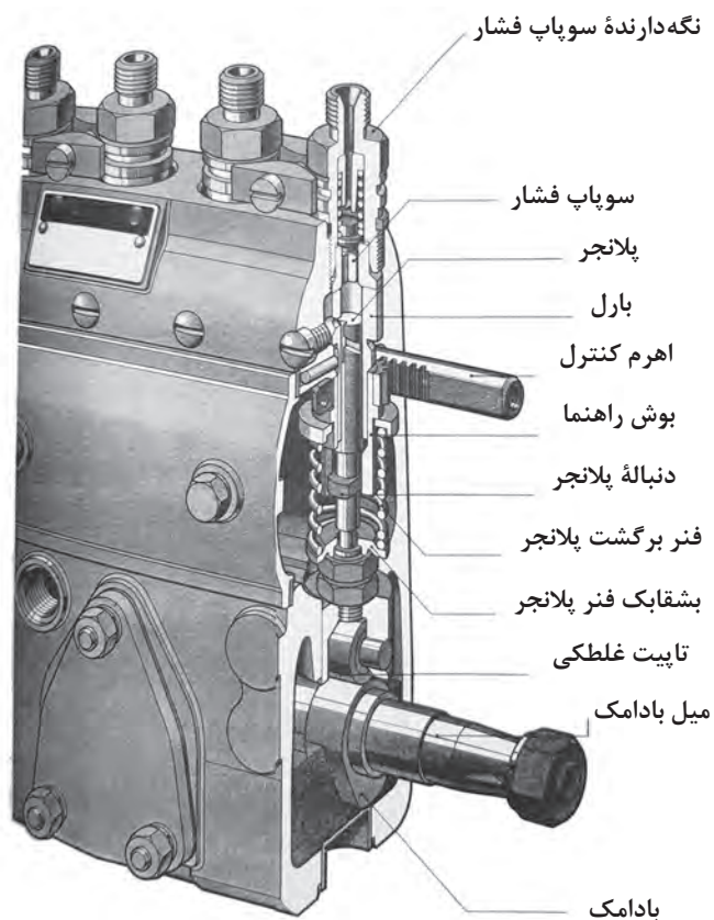
شکل ۳۱- پمپ انژکتور نوع جرک
