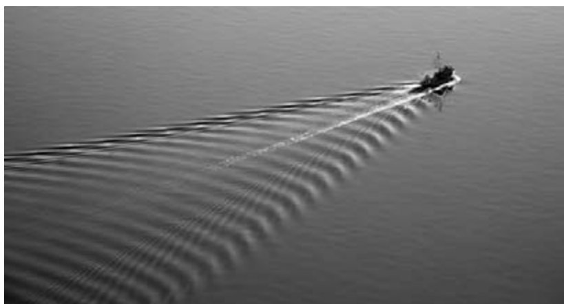
شکل ۴- تشکیل امواج بر اثر حرکت شناور
