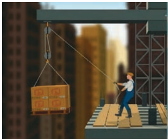
شکل ۲۶- ترکیب دو قرقه برای افزایش بهره مکانیکی
