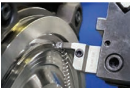
شکل ۶-۴: براده‌برداری به‌وسیله تیغه کاربیدی
