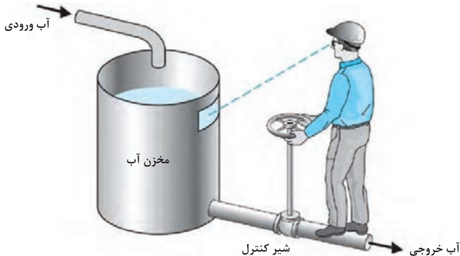
شکل ۵-۱- کنترل دستی ارتفاع آب
