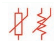
شکل ۹۶ — ۱ چند نمونه مقاومت‌های تابع ولتاژ و نماد آن
