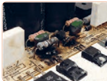
شکل ۲۴-۵ - آسیب قطعات در یک برد
