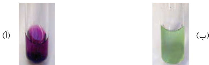
شکل ۲- دو نمونه محللول غیرآبی (آ) محللول پُدر هگزان و (ب) بنزین خودرو
