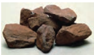
شکل ۸- سنگ معدن حاوی FeO و Fe_2O_3
