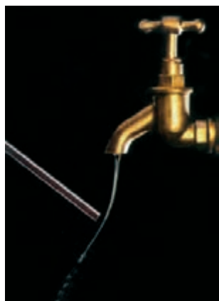
شکل ۱۴- انحراف باریکه آب به وسیله میله شیشه‌ای مالش داده شده به موی سر.
