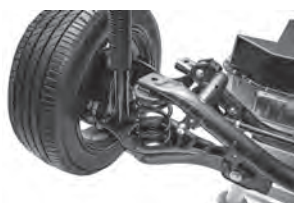
شکل ۲-۱۴ فنرهای به کار رفته در چرخ‌های خودرو
