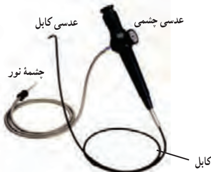
دو دسته تار نوری داخل کابل قرار دارد. (ت) یک اسباب آندوسکوپی معمولی
