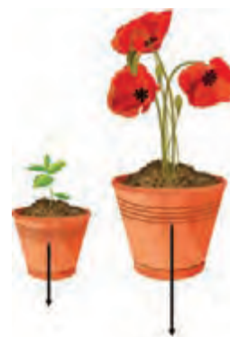
شکل ۲-۲ گاهی برای سادگی فرض می‌شود که همه جرم یک جسم در یک نقطه به نام مرکز جرم متمرکز شده است و به‌جای آنکه نیرو به قسمت‌های مختلف جسم وارد شود به این نقطه وارد می‌شود.
