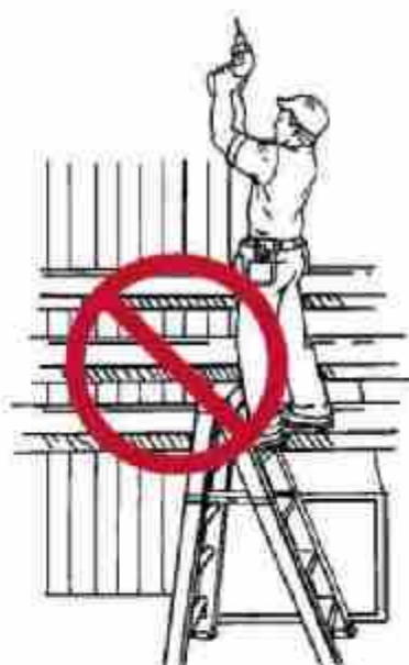
شکل ۱۴- نحوه استقرار غلط برای کار
