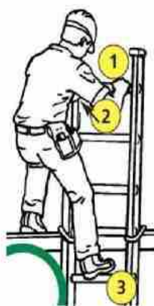
شکل ۱۵- نحوه استقرار بر روی اردبان بصورت صحیح برای کار
