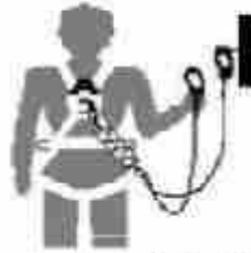
شکل ۱۱۲- نحوه صحیح استقرار در ارتفاع با ایزار محافظ‌کننده
