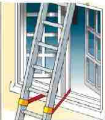
شکل ۸- نحوه تکیه‌گاه نردبان از دو طرفه
