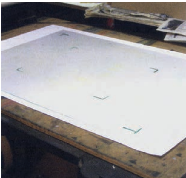
تصویر ۵۹- کاغذ نشانه‌گذاری شده نشانه‌های داخلی مربوط به محل قرارگیری کلیشه و نشانه‌های بیرونی محل قرارگیری کاغذ است.
