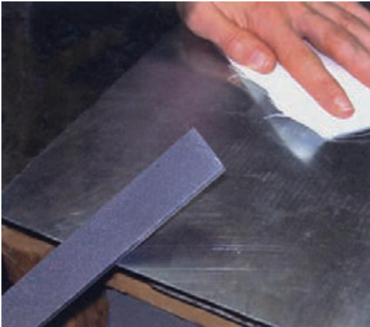
تصویر ۱۷۷- گرد کردن لبه‌ها و گوشه‌ها با سوهان (و سپس سنباده نرم)
