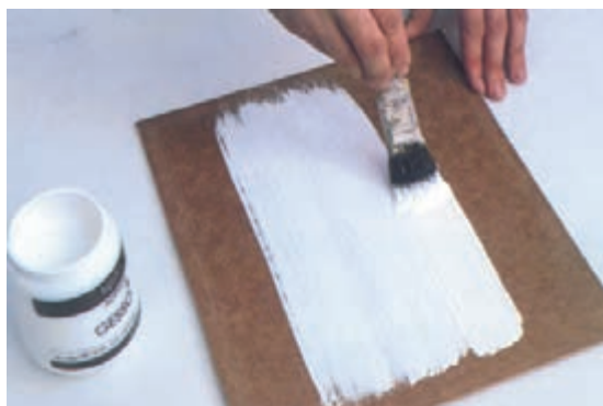
تصویر ۱- کشیدن ماده نفوذناپذیر (جسو) روی فیبر
