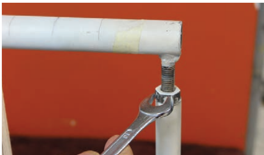
تصویر ۲-۲۹ ▲ سفت کردن مجدد پیچ‌های سر دار
