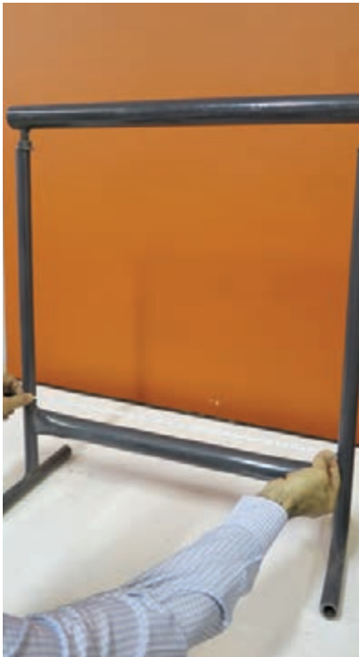
▲ تصویر ۱-۱۳ اندازه گیری فاصله دو سر پایینی راست روها
