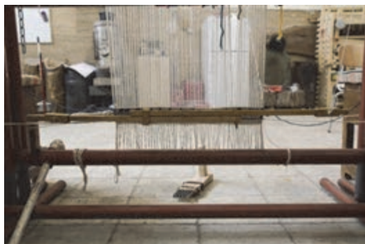
شكل ۷۷- مهيار پهناوند و بستن آن به كار
