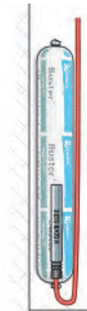
نحوه قرار دادن دینامیت چاشنی گذاری شده درون چال
