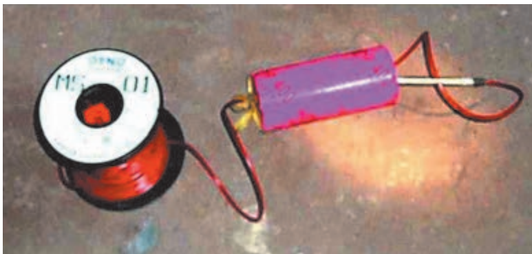
طریقه قرار دادن چاشنی درون دینامیت
