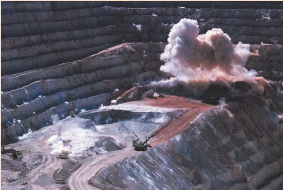
عملیات چال‌زنی و آتشیاری در معدن
