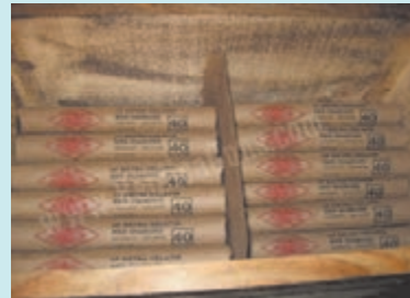
دینامیت های چیده شده درون جعبه چوبی
