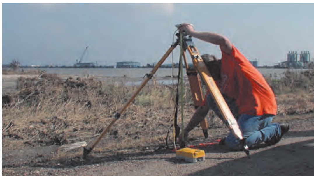
اندازه گیری ارتفاع دوربین تا سطح زمین
