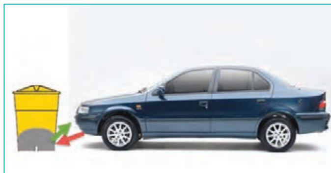
شکل ۱۶ - قرارگرفتن اشتباه ماسه در تصویر سمت راست و تشدید خسارت به خودرو در لحظه برخورد و قرارگیری درست ماسه در تصویر سمت چپ
