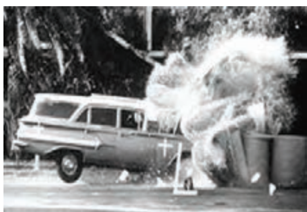
شکل ۱۱- عملکرد ضربه‌گیر وزنی بشکه‌ای شکل در هنگام برخورد
