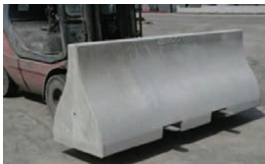
شکل ۵۶- بارگیری نیوجرسی با لیفتراک در محل کارخانه
