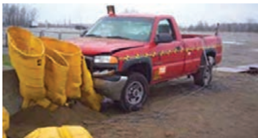
شکل ۷- ضربه گیر وزنی از نوع بشکه های پلاستیکی
