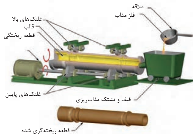
شکل ۹- ریخته‌گری گریز از مرکز
