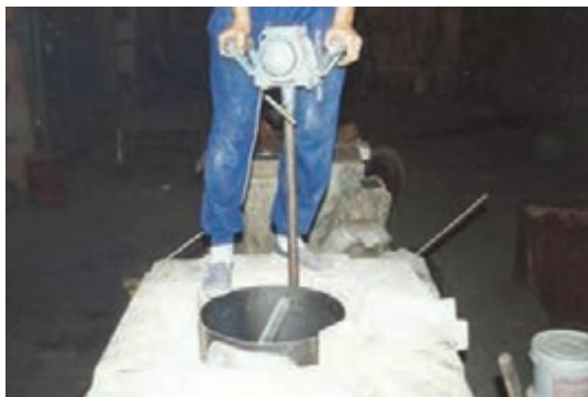
شکل ۱۹- نحوه کوبش دیواره کوره توسط کوبه ماشینی
