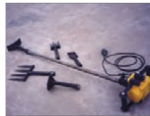
شکل ۱۲- کوبه ماشینی با سرهای قابل تعویض
