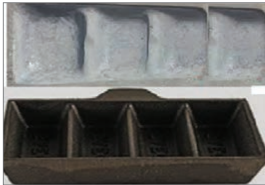
شکل ۵- قالب ریژه شمش ریزی
