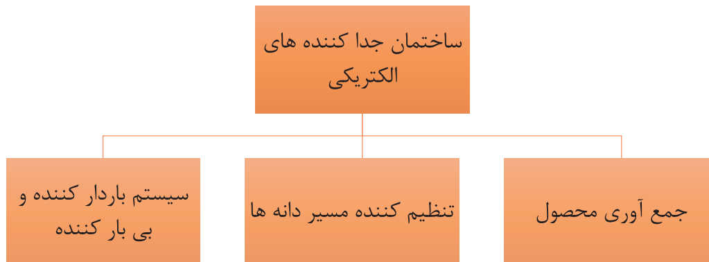
شکل ۳۷- ساختمان جداکننده‌های الکتریکی
