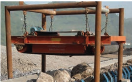
شکل ۲۶- جدا کننده های مغناطیسی معلق نوار متقاطع
