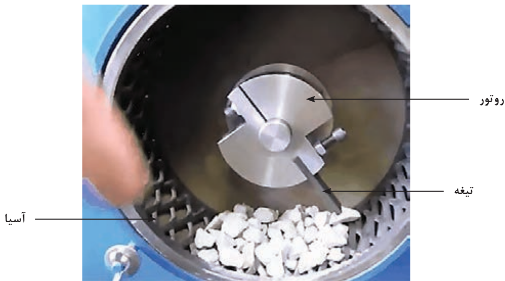
شکل ۳- نمای داخلی آسیای استاندارد ساینده‌گی باند
