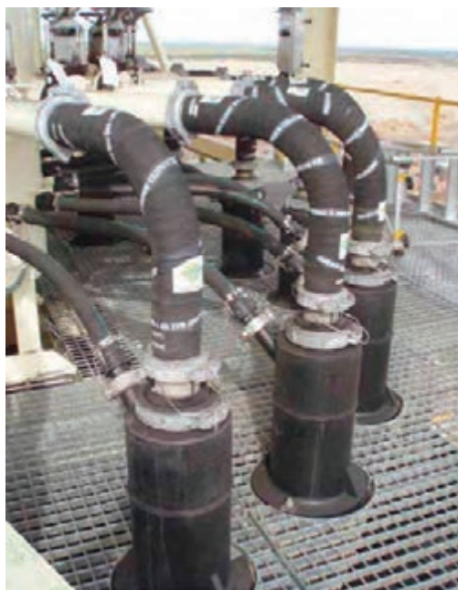
شکل ۲۲- جت‌های تزریق پالپ در سلول فلوتاسیون جیمسون
