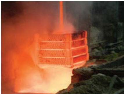
شکل ۳۰- کربوره کردن مایع در حمام نمک
