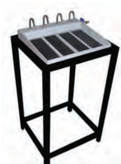
شکل ۱۲- صفحه‌های صاف سنبناده کاری نمونه‌های متالوگرافی
