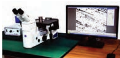
شکل ۷- نمونه‌ای از میکروسکوپ نوری مورد استفاده در متالوگرافی
