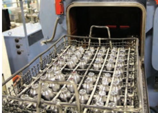
شکل ۱۶- قرارگیری سبد حاوی قطعات جلوی در کوره
