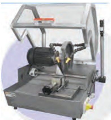
شکل ۱۱- کاتر مخصوص برای برش نمونه‌ها
