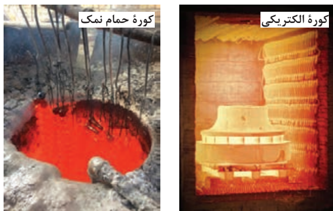
شکل ۲۱- هم‌دما کردن قطعات در کوره‌ها
