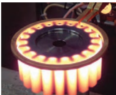
شکل ۳۳- سخت کردن چرخ دنده به روش القا
