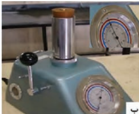
شکل ۳۳- مراحل انجام آزمایش قابلیت نفوذ گاز
