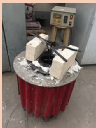
شکل ۲۵- وارد کردن نمونه‌ها در حمام نمک
