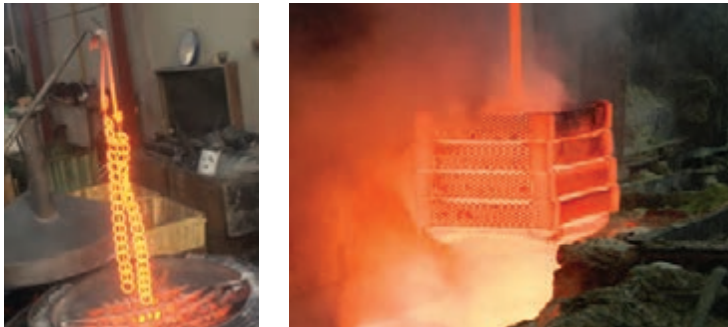
شکل ۲۲- روش‌های مختلف خارج کردن قطعه از کوره
