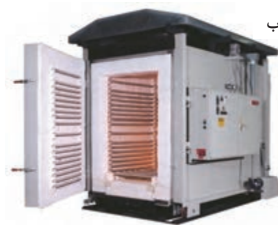
شکل ۲- انواع کوره‌های الکتریکی، الف) بدون فن، ب) فن دار
