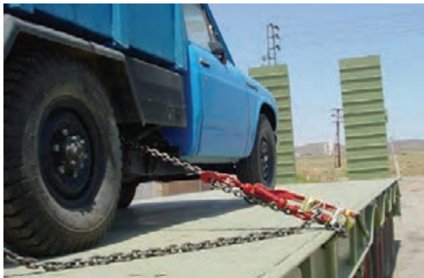
شکل ۲۲- نمونه‌ای از مهار نادرست یک اتومبیل
