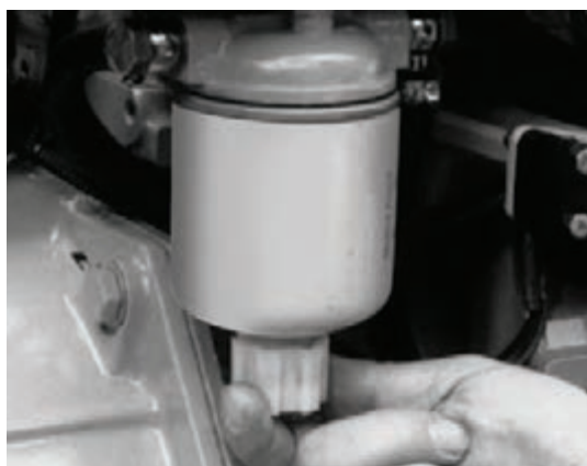
تخلیه فیلتر سوخت
