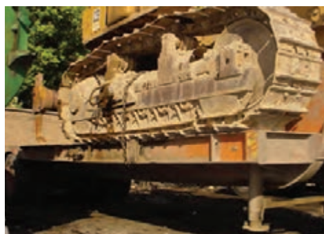
شکل ۳۰- بستن بلدوزر با یک زنجیر آن هم با عبور از چرخ شنی
