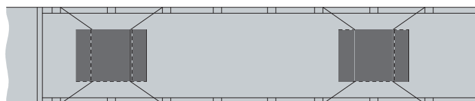
شکل ۳۸- نحوه مهار عرضی رل‌ها
