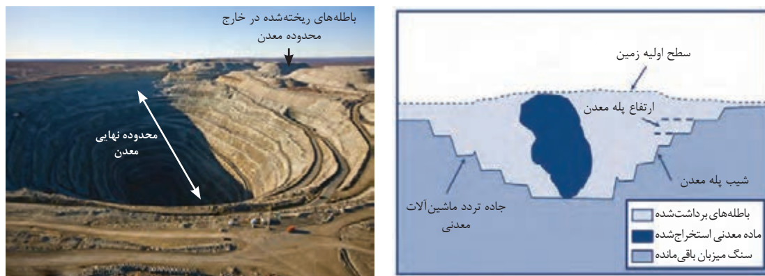
یک معدن در حال استخراج به روش پله ای و شکل شماتیک مقطع عرضی آن
