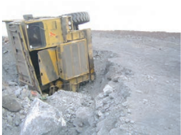
حادثه برای ماشین‌آلات معدنی در اثر عدم کنترل مسیر جاده
