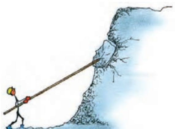
لق‌گیری با چوب بلند و از پایین
