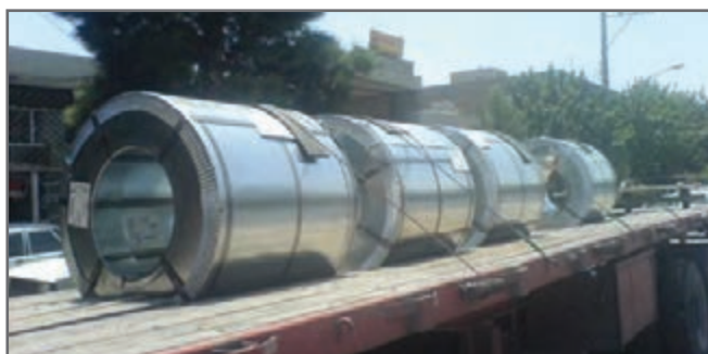
شکل ۴۲- نمونه‌ای از استقرار رول فلزی به صورت طولی با کمک جارولی
