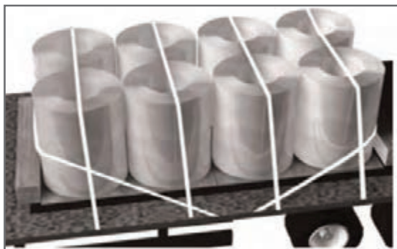
شکل ۳۴- نحوه کاهش بندها در مهار بارهای استوانه‌ای
