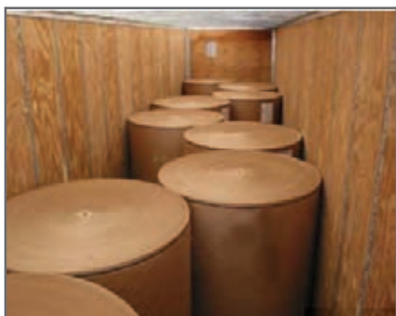
شکل ۳۶- نمونه‌ای از مهار رول‌های کاغذ با کمک دیواره‌های بارگیر
