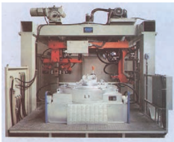
شکل ۱۰- ماشین ریخته‌گری تحت فشار کم
