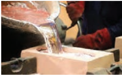
شکل ۳- ریخته‌گری فلز آلومینیوم
