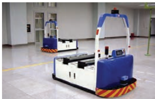
شکل ۲۸- ماشین اتوماتیک هدایت شونده با لیزر
