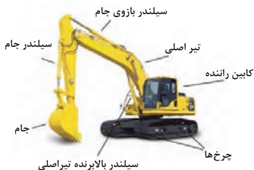
شکل ۵- قسمت‌های مختلف بیل مکانیکی
