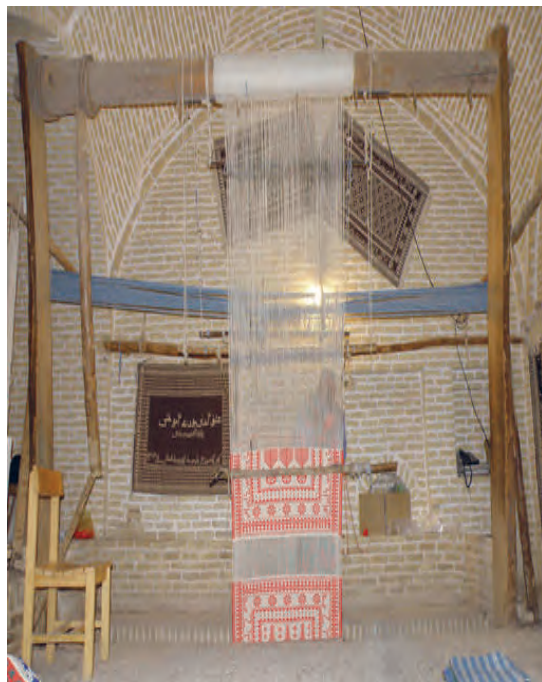
شکل ۲۲-۱ دار چوبی و ثابت برای بافت زیلو
