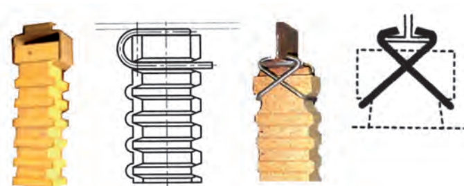
شکل ۴۲- برخی از واسط‌های فلزی برای اتصال انکرهای سرامیکی به جداره
