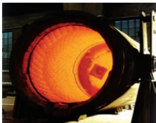
شکل ۵ - پاتیل خالی حمل مذاب فولاد
