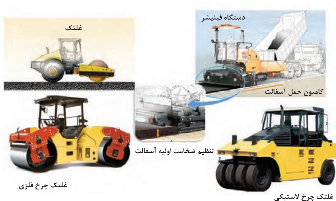
شکل ۳۲ - تجهیزات پخش و تراکم آسفالت
