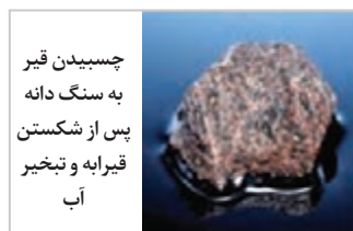
شکل ۲۵- فرایند شکستن قیرابه در زمان اختلاط با سنگ دانه ها
