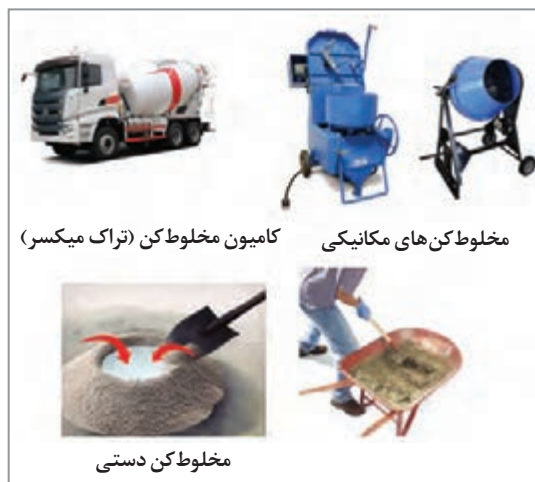
شکل ۱۳- انواع روش های اختلاط بتن
