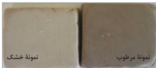
شکل ۲- تأثیر انقباض خشک در کاهش ابعاد نمونه
