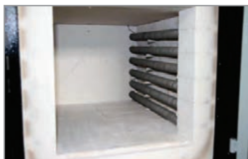
شکل ۱۲- نصب المنت بر روی پایه
