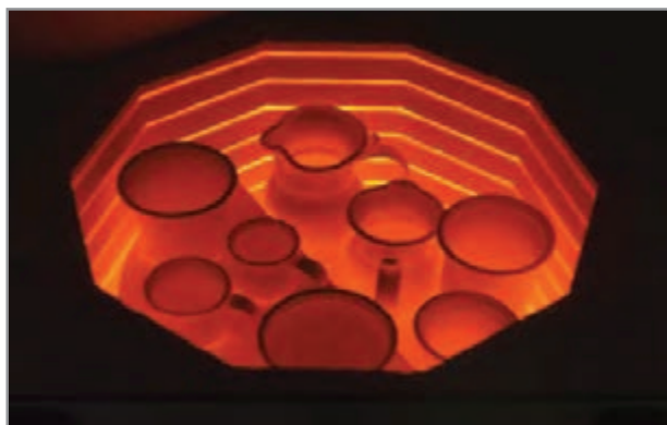
شکل ۲- بدنه‌های سرامیکی در حال پخت
