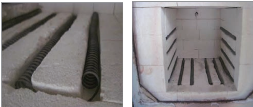
شکل ۱۳- نصب المنت درون شیار
