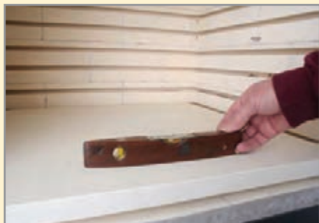
شکل ۲۸- بررسی تراز بودن کف کوره کارگاهی
