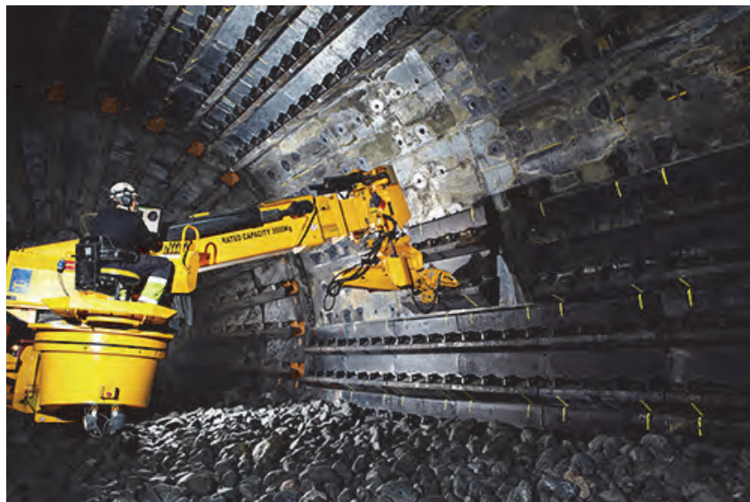
نحوه تعویض آسترهای دستگاه آسیا
