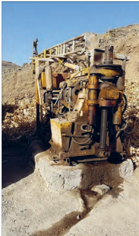
دستگاه حفاری قرار گرفته بر روی فونداسیون
