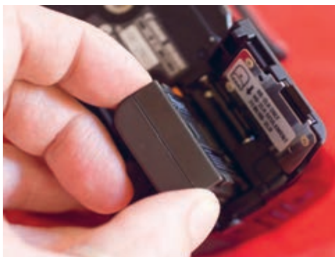
شیوه صحیح نصب باتری دوربین عکاسی
