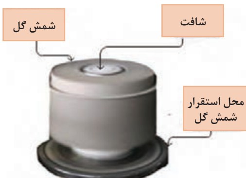
شکل ۱۵- استقرار شافت و شمش گل
