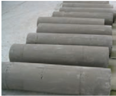
شکل ۲۰- برش شمش با طول مناسب
