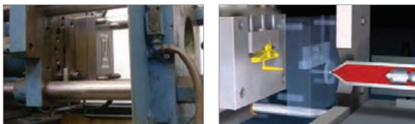
شکل ۲۱- قالب تحت فشار و تزریق
